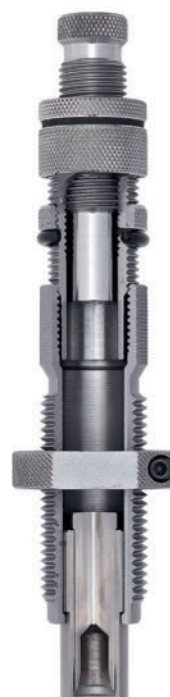
Coupe de l'outil d'enfoncement et de sertissage Hornady. En bas, le manchon flottant permet un alignement parfait de la balle et de l'étui.
