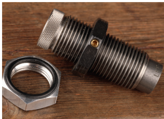
La bague de réglage à joint torique de cet outil Lee Factory Crimp a été remplacée par une bague à vis.
