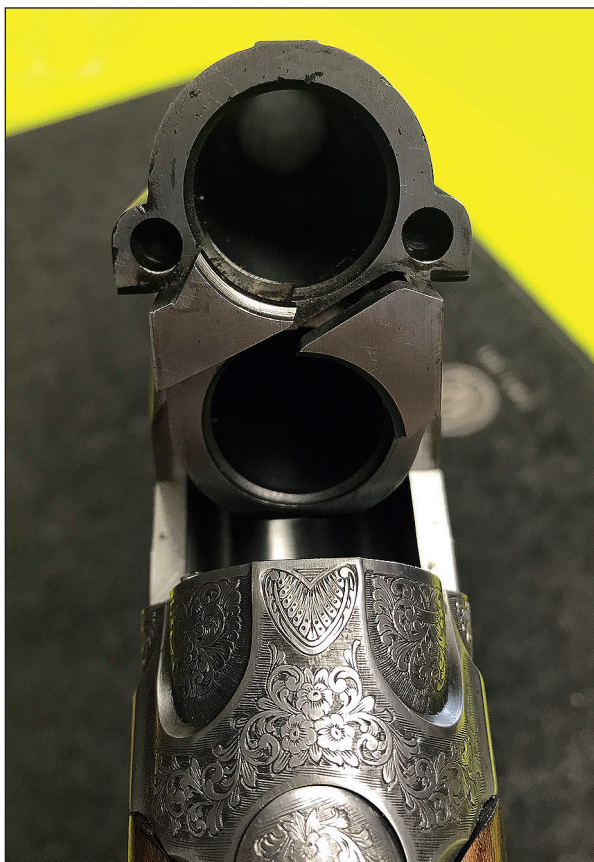
Le verrouillage d'un Beretta de grande série, inchangé depuis les S55. Deux mortaises sont usinées dans les ailerons du canon supérieur où s'engage le verrou tronconique.
