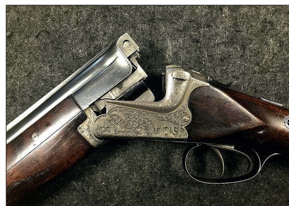
Trois verrous, trois types de bascule. En haut, le système de fermeture médian à la base du canon supérieur permet une bascule très basse pour ce Beretta SO. Ci-dessus à gauche, le Browning B25, avec sa bascule plus haute du fait de la présence de crochets sous les canons. À droite, le Merkel et sa bascule haute du fait de ses crochets bas et de son verrou Greener supérieur.
