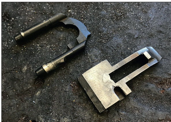
Deux verrous de superposé, le tronconique en U d'un Beretta et le plat et épais d'un Browning.
