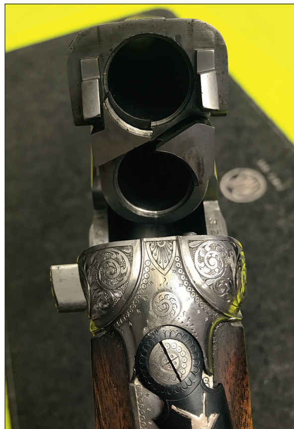
Le verrouillage des Beretta SO et ASEL. Deux verrous, semblables à celui du Woodward, viennent se bloquer dans le tonnerre de bascule.
