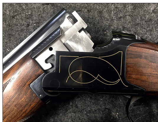
Trois verrous, trois types de bascule. En haut, le système de fermeture médian à la base du canon supérieur permet une bascule très basse pour ce Beretta SO. Ci-dessus à gauche, le Browning B25, avec sa bascule plus haute du fait de la présence de crochets sous les canons. À droite, le Merkel et sa bascule haute du fait de ses crochets bas et de son verrou Greener supérieur.
