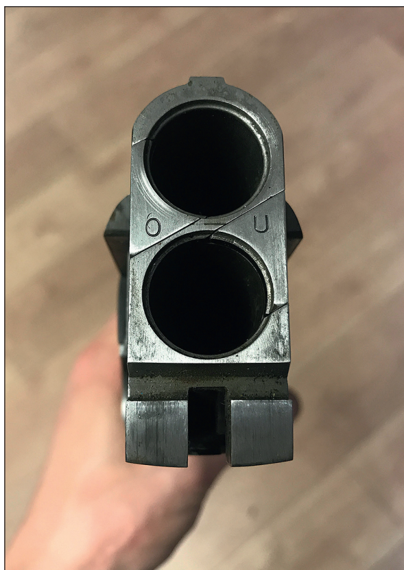
Les deux crochets de fermeture d'un Browning, ici un B25. L'épais verrou inférieur pénètre dans l'usinage réalisé au-dessus des deux crochets.
