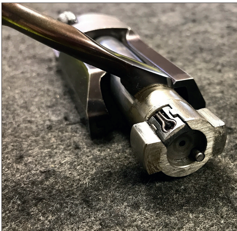
La Mauser 66 et sa culasse logée dans un chariot, on parlait alors de culasse télescopique.
