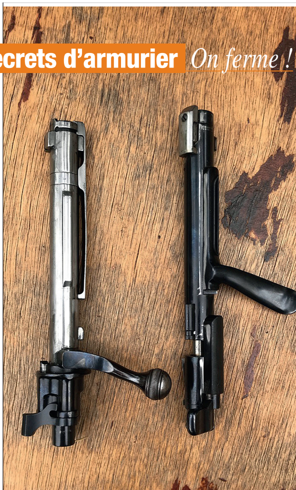
Toujours la Mauser et la Schönaauer, la seconde ne possède pas de long extracteur à lame.
