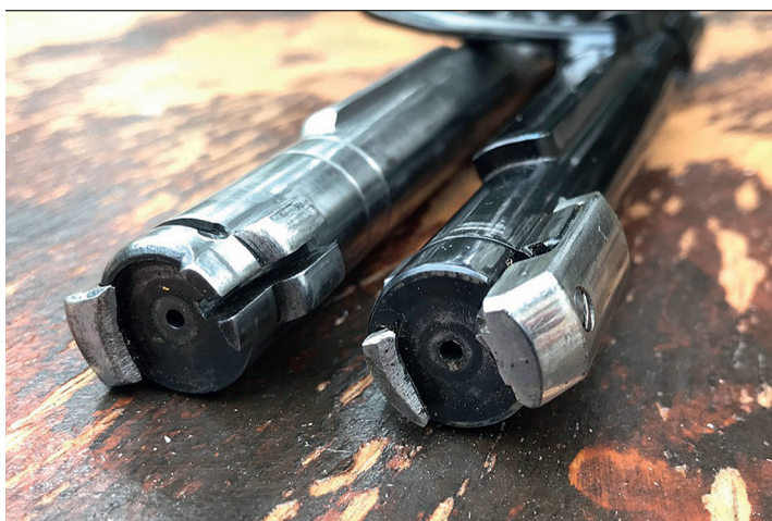
La culasse se verrouille le plus souvent en tête, dans un pont avant ou dans le canon, par une rotation pour bloquer, un, deux, trois ou parfois neuf tenons.
