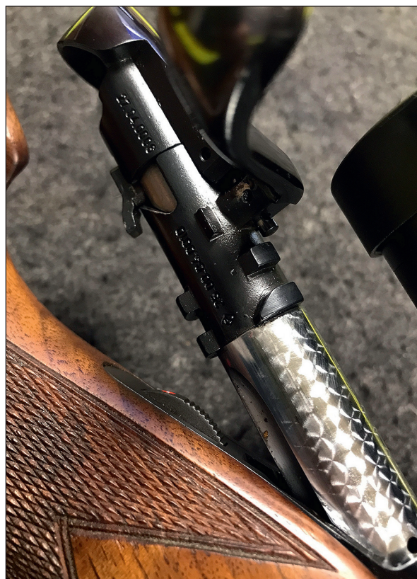
Les tenons arrière de la Steyr-Mannlicher modèle 69, souvent appelée à tort modèle M.
