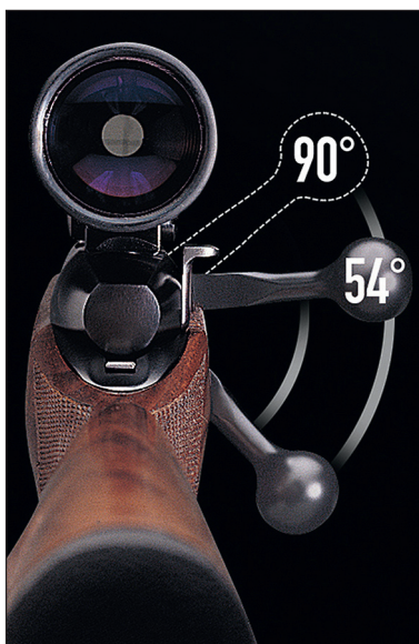
Avec une Weatherby, comme ici, le levier monte moins haut qu'avec une Mauser (90 degrés), la lunette peut être fixée au ras du canon sans gêne.
