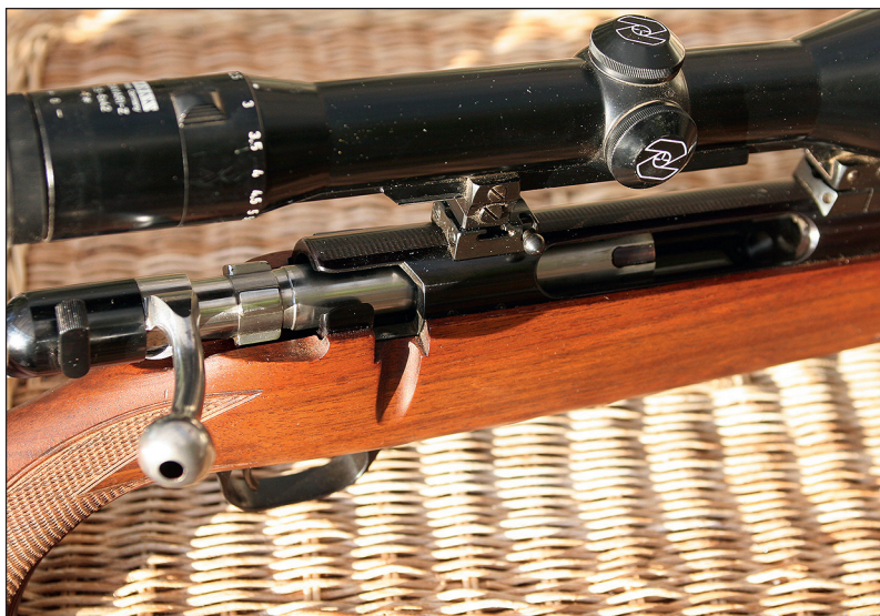
La Schultz & Larsen modèle 65 et ses quatre tenons arrière autorisait un verrouillage de seulement 45 degrés, rapide et efficace.
