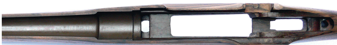
La réalisation d'un bedding en résine époxy n'a de simple que son apparence. L'opération est technique et impose de bien préparer la crosse et la mécanique : boucher les trous au scotch et enduire de graisse pour permettre le démoulage final.
