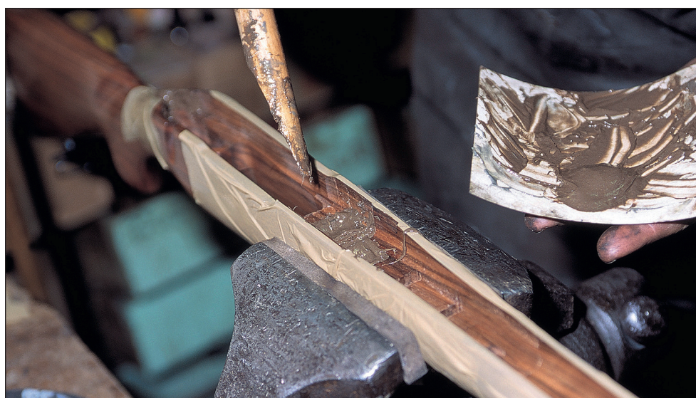
La réalisation d'un bedding en résine époxy n'a de simple que son apparence. L'opération est technique et impose de bien préparer la crosse et la mécanique : boucher les trous au scotch et enduire de graisse pour permettre le démoulage final.
