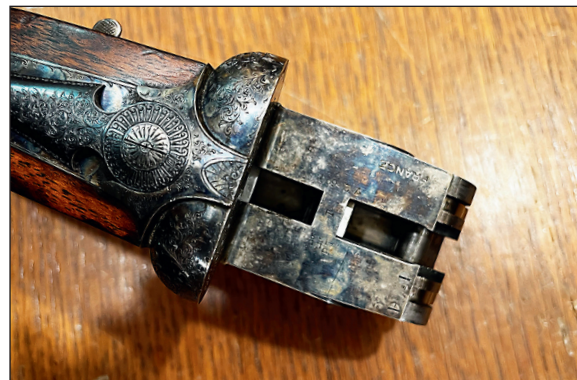
Deux crochets et deux verrous plats, qui sont en fait une seule et même pièce d'acier usinée, constituent le double verrouillage Purdey, le plus connu au monde.
