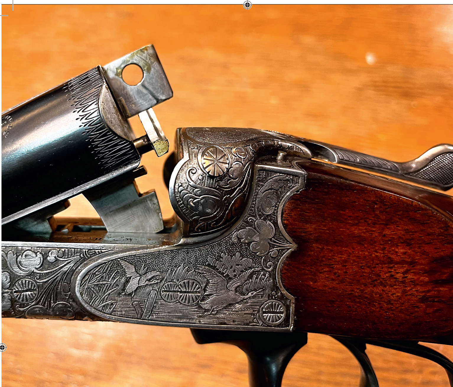
À gauche le verrou supérieur en tête de poupée créé chez Westley Richards par Anson & Deeley.
