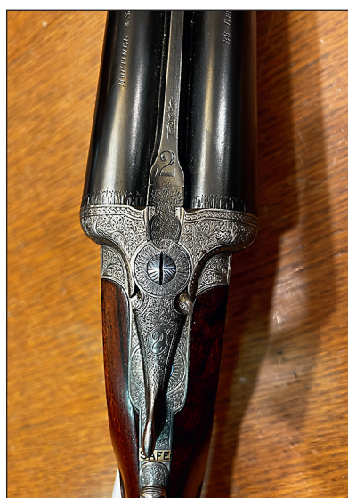
À gauche le verrou supérieur en tête de poupée créé chez Westley Richards par Anson & Deeley.
