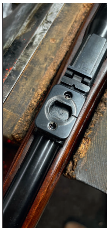
L'embase avant du montage pivotant dans laquelle s'engage la partie mâle du montage fixée directement sur la lunette.
