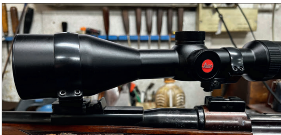
Le montage EAW est le plus connu et le plus répandu des montages optiques pivotants.
