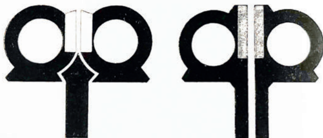
Canons à crochets rapportés (à gauche) et en demi-blocs (à droite).
